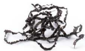
无断屑槽 without chipbreaker
