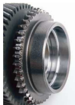
齿圈内孔粗加工 gear ring inner hole rough machining
